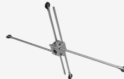
Accessorio per il centraggio della spazzola Rotair. Permette di centrare la spazzola nel condotto e quindi di esercitare una pressione uguale su tutto il diametro del condotto, evitando le oscillazioni. Avendo le ruote permette un migliore scorrimento e facilita la manipolazione del tubo da parte dell'operatore. Valido per condotti da Ø200 a 600 mm.
