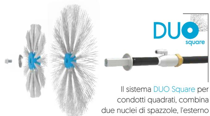
Il sistema **DUO Square** per condotti quadrati, combina due nuclei di spazzole, l'esterno è dimensionato all'altezza del condotto e l'interno con le dimensioni appropriate per per ottenere una spazzolatura efficace negli angoli.
