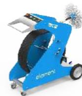
**ELEMENT.** Apparecchiatura automatica di pulizia con spazzole pneumatiche per i condotti dell'aria condizionata.
